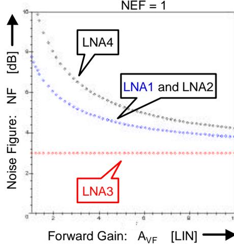
Fig. 6: LNA Noise figure  $F_{dB}=10\text{Log}_{10}(F)$ .
